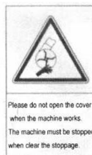
علامت اخطار ایمنی ۹: در هنگام کار از برداشتن پوشش خودداری کنید . در صورت وجود مانع ماشین باید متوقف گردد.
