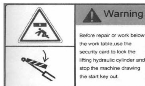
علامت اخطار ایمنی ۷: پیش از تعمیر یا کار زیر هد دستگاه توسط کارت ایمنی ، سیلندر هیدرولیکی بالا برنده را قفل کنید و دکمه کشش را متوقف نمایید
